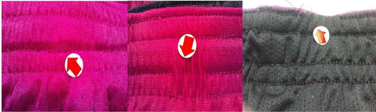
**Gambar 3. Cacat Jahitan Yang Disebabkan Oleh Kesalahan Jalur Pemasangan Benang (Thread Guide) Yang Tidak Melewati Lubang Needle Bar<sup>6</sup>**
